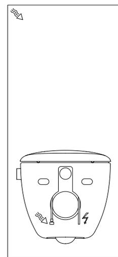
mit Keramik für Wasseranschluss bei 19,5 cm
