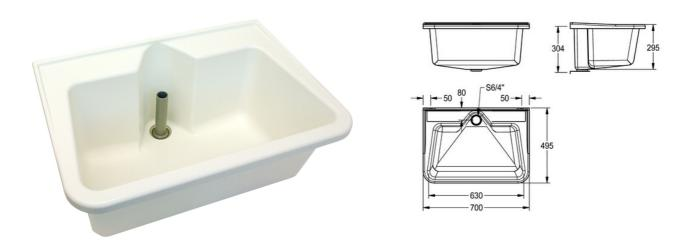
Mehrzweckbecken aus glasfaserverstärktem Polyester-Recyclingmaterial, Standrohrventil 1 1/2", integrierte Laschen für Wandmontage, inkl. Mauerschrauben.
