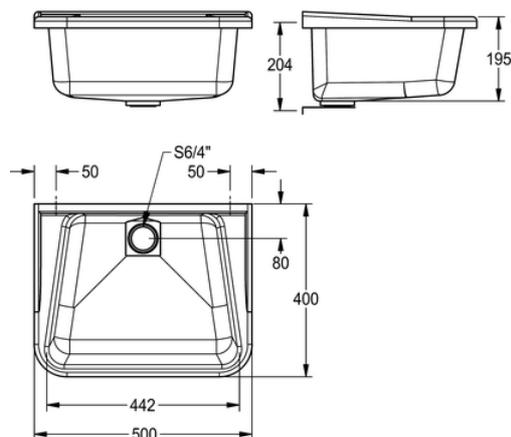
Mehrzweckbecken aus glasfaserverstärktem Polyester-Recyclingmaterial, Standrohrventil 1 1/2", integrierte Laschen für Wandmontage, inkl. Mauerschrauben.
