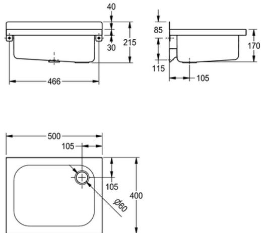
Ausgussbecken für Wandmontage, Chromnickelstahl, Oberfläche seidenmatt, Materialstärke 1,2 mm, fugenlos eingeschweisstes Becken mit Muldenmass 420x400x170 mm, abgerundete Kanten, 1 1/2" Stopfsieb, Ablauf hinten rechts, 40 mm Wandzarge, inkl. Edelstahlsschrauben und Dübel.
