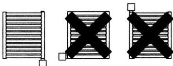
1. Heizkörper wird nur mit einer elektrischen Heizpatrone betrieben und somit nicht an die Zentralheizung angeschlossen.
